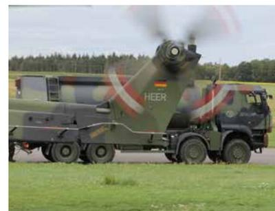
Die Heeresflieger sind mit ihrem Fuhrpark verlegefähig. Eine Betankung im Gelände ist mit den Allradfahrzeugen überall möglich. Hier ein geschützter Straßentankwagen des Luftfahrzeugversorgungszuges der 4./30.
