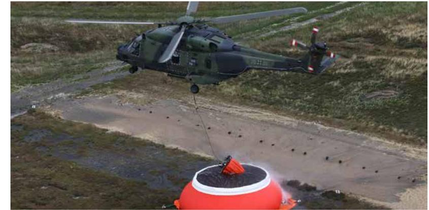
Bei der Wasseraufnahme aus dem FlexFit-Behälter müssen die Piloten auf den Zentimeter genau arbeiten.
